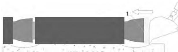
挖掘机挖斗安装示意图
